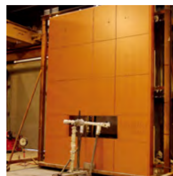
ACM 레인 스크린 외관 뒤 4인치 (100mm) 두께의 Kingspan 절연 금속 패널 테스트
