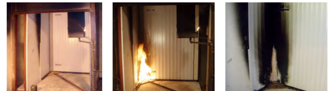
테스트 설정 시험중 시험 후 보호 탄화막 형성 검사
