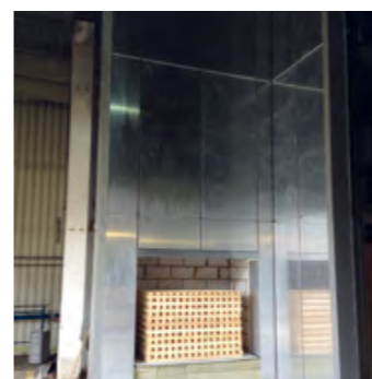
테스트 설정 - 카세트에 알루미늄 그리드가 있는 Kingspan BENCHMARK 외관 패널
