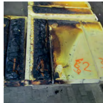
금속 표면이 제거된 테스트 종료시 패널의 절연 표면에 보호 탄화막이 형성됨
