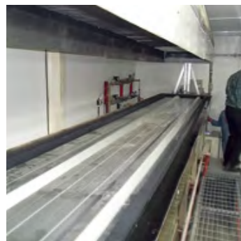
스타이너 터널 시험 장치
