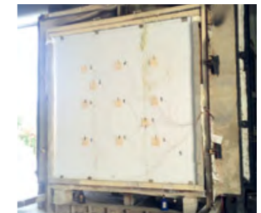
QuadCore™ 패널 조립품의 외부면 60분 노출 완료 후.
