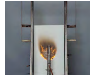
3 분간의 테스트 진행 - 표면 연소 및 적은 양의 연기 배출에 주목
